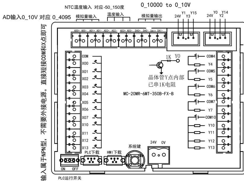
输入属于NPN型，不需要外接电源，直接短接COM和X点即可
