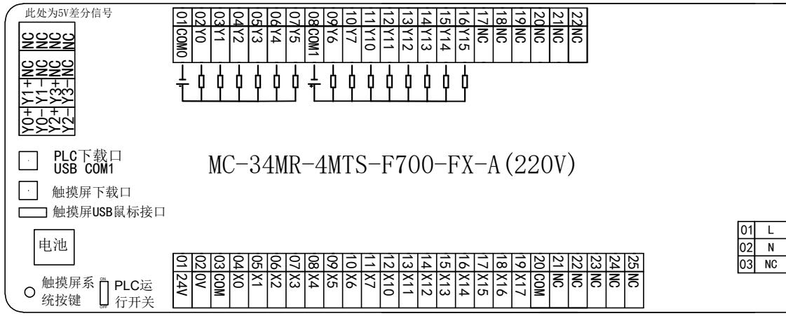
输入属于NPN型，不需要外接电源，直接短接COM和X点即可。
